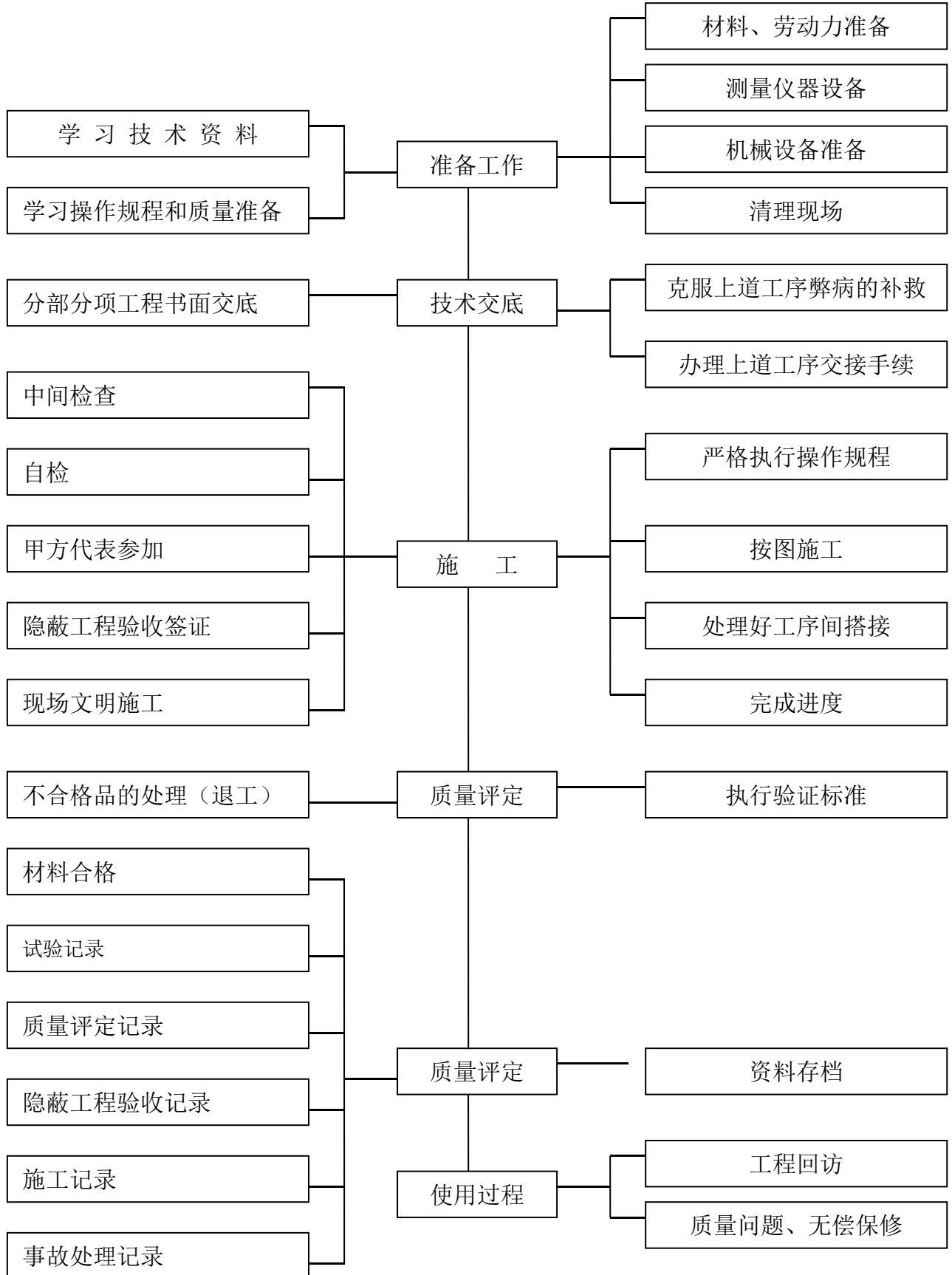
施工质量控制检查程序图
